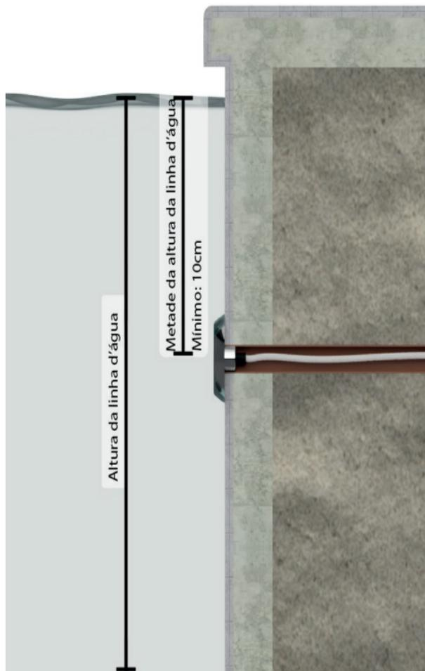
Exemplo: Altura da linha d'água é de 140 cm, a altura ideal para instalação do refletor é de 70 cm.
