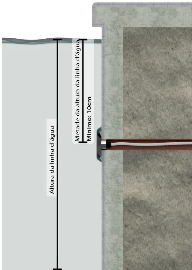
**Exemplo:** Altura da linha d'água é de 140 cm, a altura ideal para instalação do refletor é de 70 cm.
