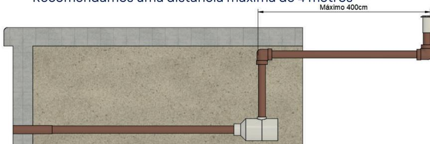
Caso desejar juntar as entradas de ar dos canhões, deverá ser usada uma válvula de pé com crivo (não fornecidas) ao invés das válvulas de ar fornecidas com o conjunto de hidromassagem.
